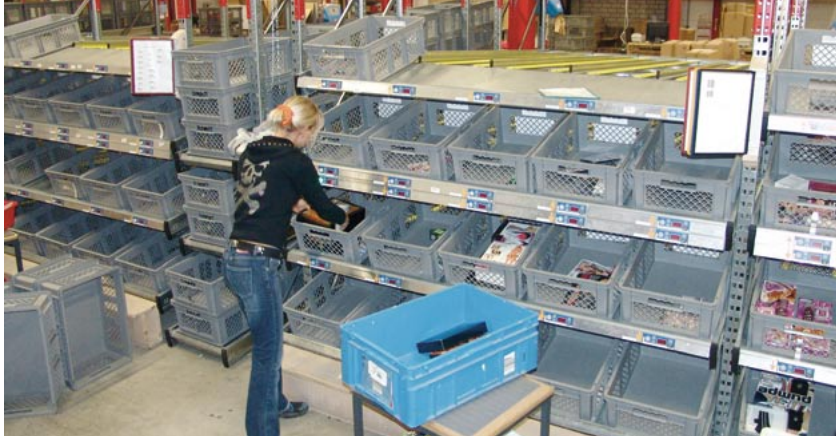
In der neuen Durchlaufregalanlage mit Pick-by-Light-Funktionalität kann ein Auftrag auf bis zu 36 Kanälen gleichzeitig kommissioniert werden. Pro Kanal sind bis zu 6 Behälter möglich.
