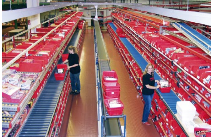
Kommissionierung für den Versandhandel: Mitarbeiter schieben Kommissionierbehälter auf Rollförderbändern an einer Fachbodenregalanlage entlang und befüllen diese mit den angeforderten Positionen.
